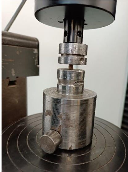
21. ábra 4×4×6 mm-es próbatest nyomóvizsgálata
