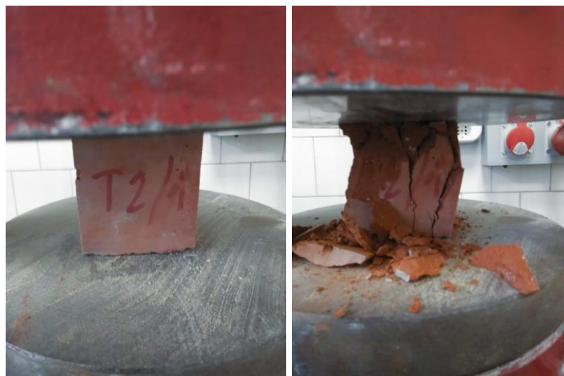
10. ábra Nyomószilárdsági vizsgálat: téglaminta törés előtt (bal), és után (jobb, fotó: ICM Kft., 2021)
