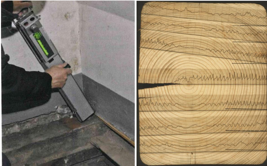
7. ábra Födémgerenda vizsgálata rezisztográffal (bal, Scheiding et al., 2021), biotukus károsodásoktól mentes gerenda ellenállási görbéi (jobb, Resistograph, 2022)
