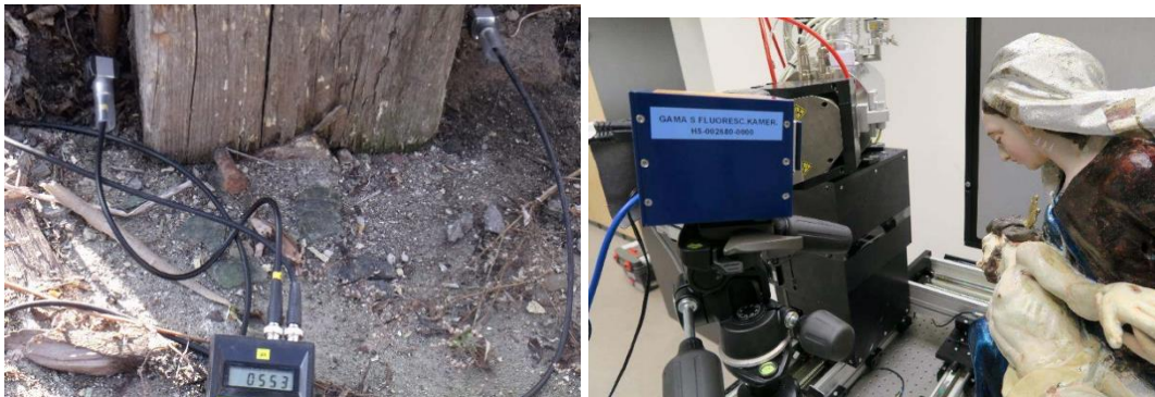
8. ábra Roncsolásmentes, ultrahangos- (bal - Fakopp, 2022) és CT/XRF –vizsgálat (jobb - Rik et al., 2017)
