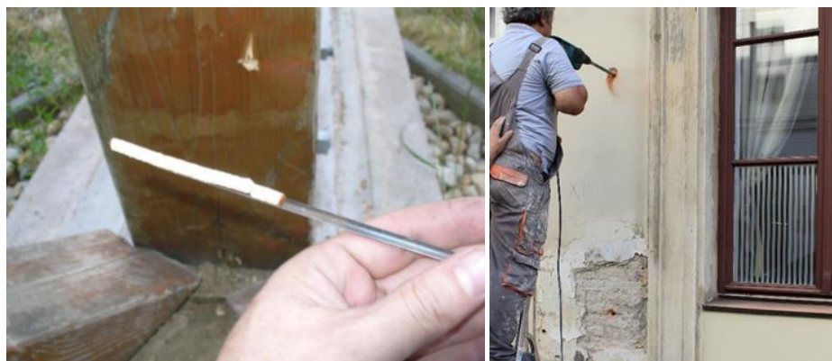
9. ábra Faminta vételezése kézi magfúróval (bal), porminta gépi mintavételezése falazatból (jobb- fotó: ICM Kft., 2021)
