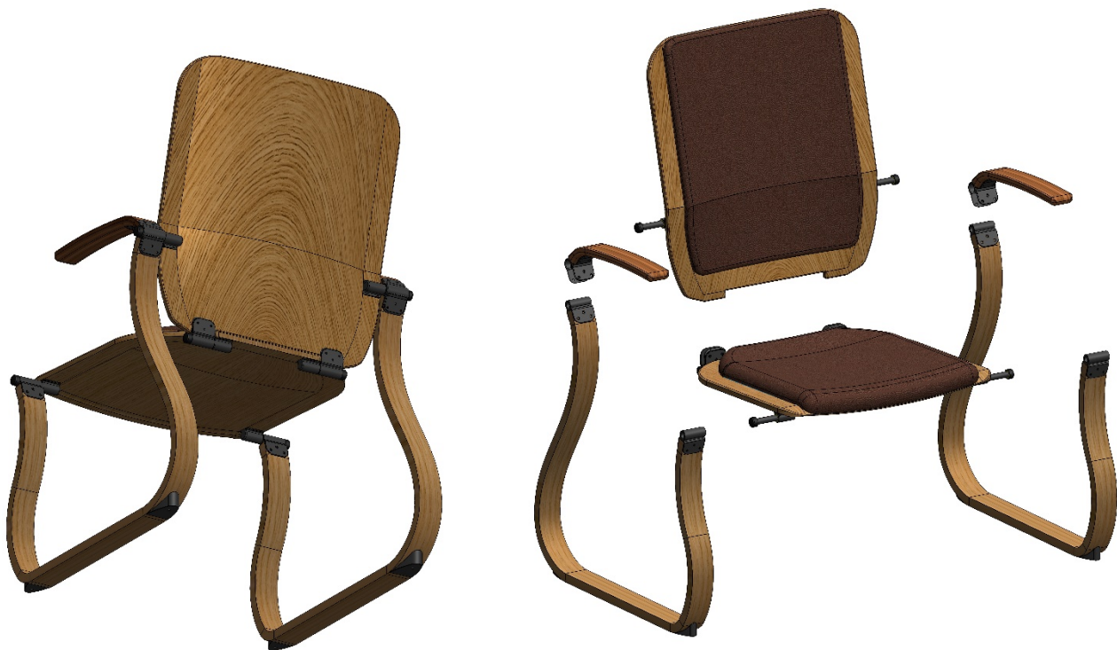
20. ábra Csomópontok elhelyezkedése és részegységekre bontott robbantott nézet
