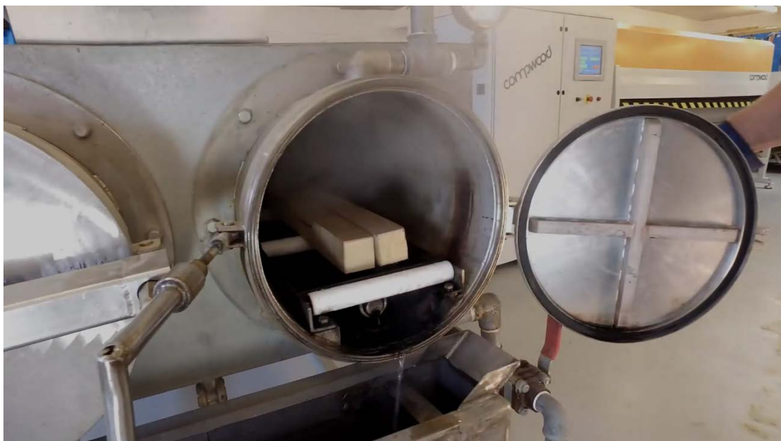
4. ábra Autoklávban gőzölés a Compwood technológiánál [web6]
