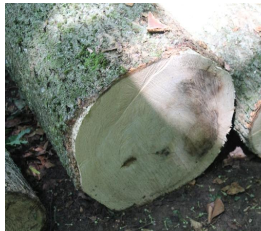
10. ábra: Fiatalkori mechanikai sérülések nyomai a bütűn
