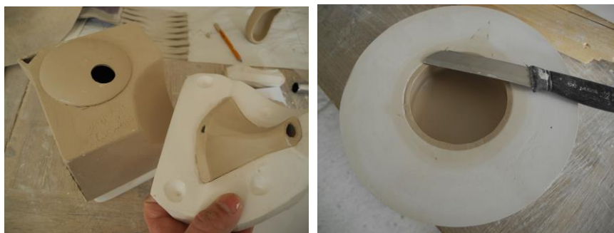
36., 37. sz.ábrák: Porcelánmassza formába öntése
