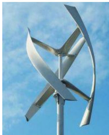
5. ÁBRA FÜGGŐLEGES (VERTIKÁLIS) ROTORÚ SZÉLGENERÁTOR Forrás: http://www.megujuloenergiak.eu/vertikalis-szelgenerator
