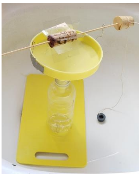
15.ÁBRA FORGÓLAPÁTOS EMELŐSZERKEZET Forrás: https://www.education.com/science-fair/article/water-produce-energy/
