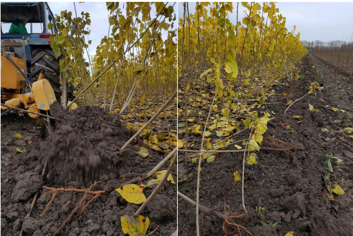
14. ábra: NNY gyökeres dugvány alávágása és kiemelése rázóvillás kiemelőgéppel
