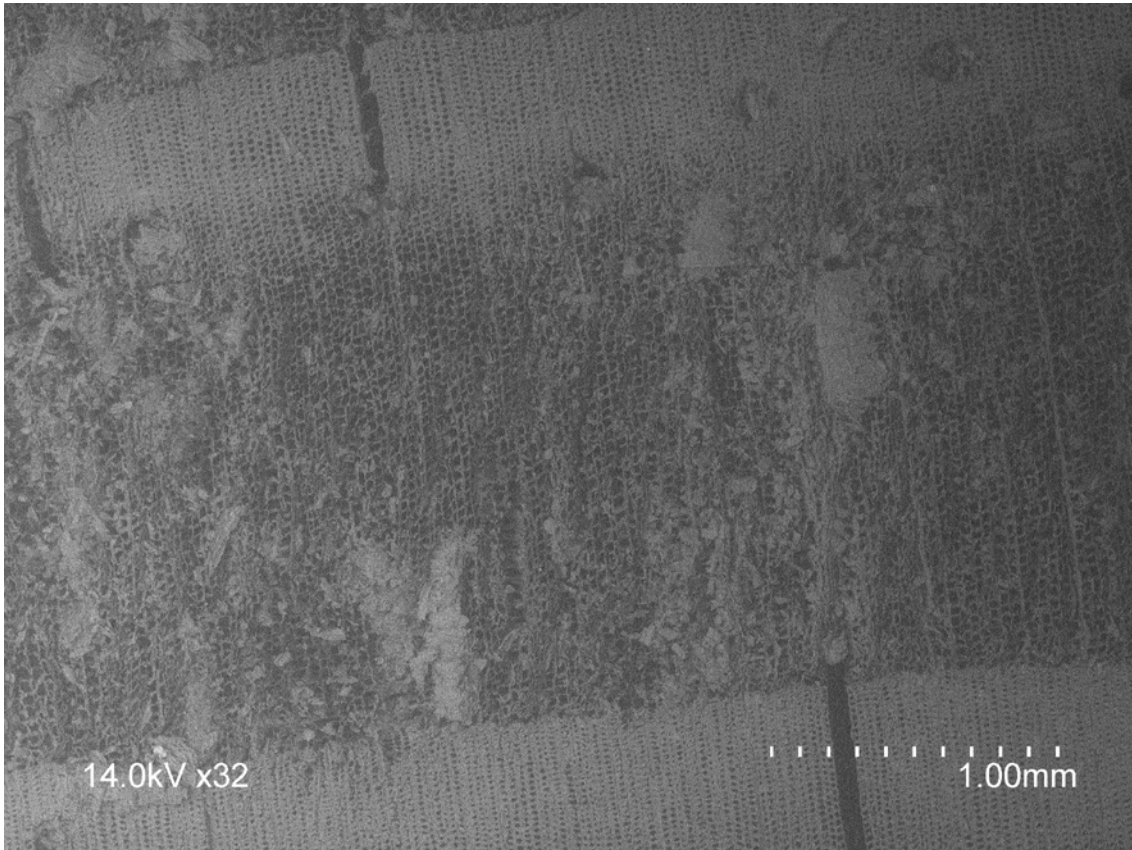
34. ábra Erdeifenyő évgyűrűjének bütümetszetén készült SEM-SE kép, 3-4% körüli gombabontás
