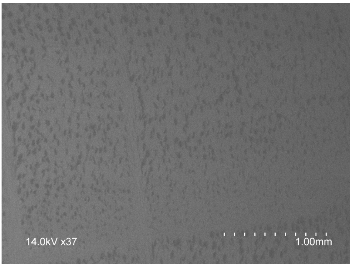
43. ábra Bükk egy évgyűrűjének bütü metszetén készült SEM-SE kép, 11%-os gombabontás, az edényrendszer kezd felbomlani
