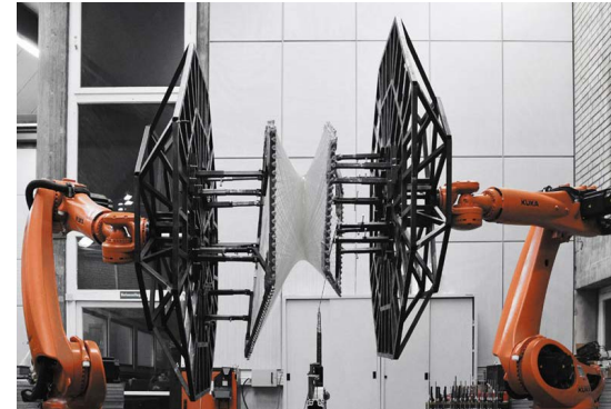
két hattengelyes robotkar csévéli az egyik falelem első rétegét
