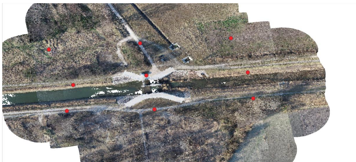
4. ábra: Georeferáláshoz felhasznált illesztőpontok
