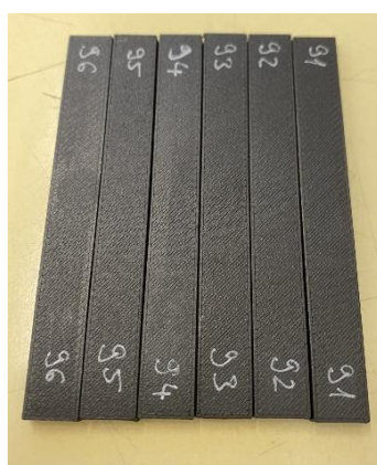
19. ábra: Hajlító próbatestek és a hajlítóvizsgálat eredménye Exp1 esetében
