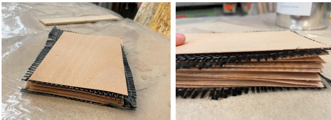
20. ábra Rétegek összeállítás
