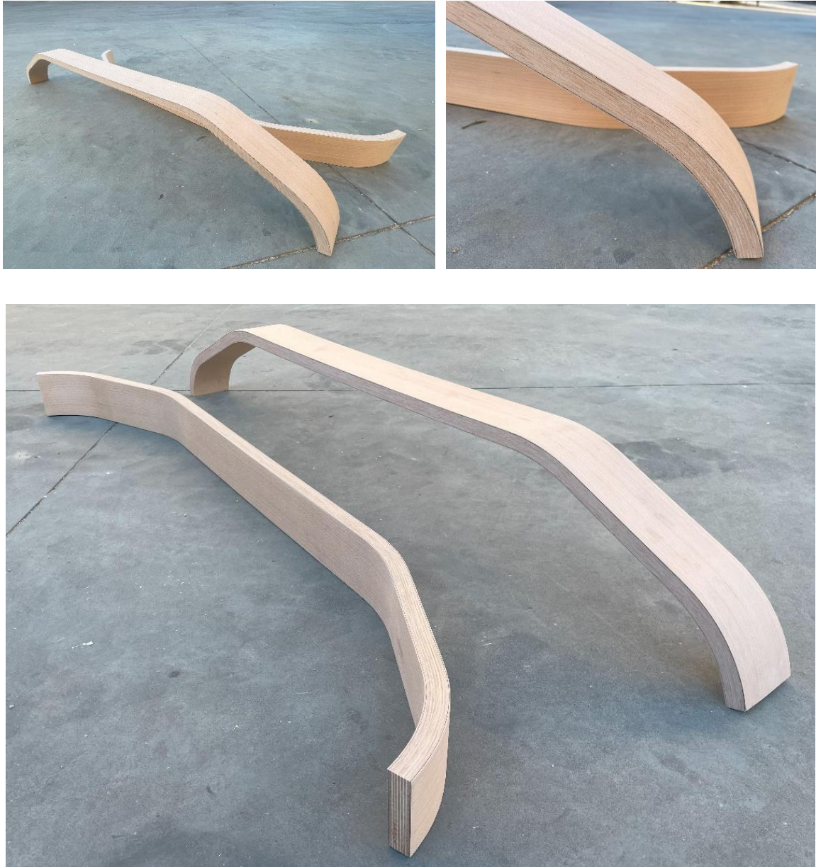
33. ábra Bükk-szénszálerősített Idompréselt rétegeltlemez lökhárító
