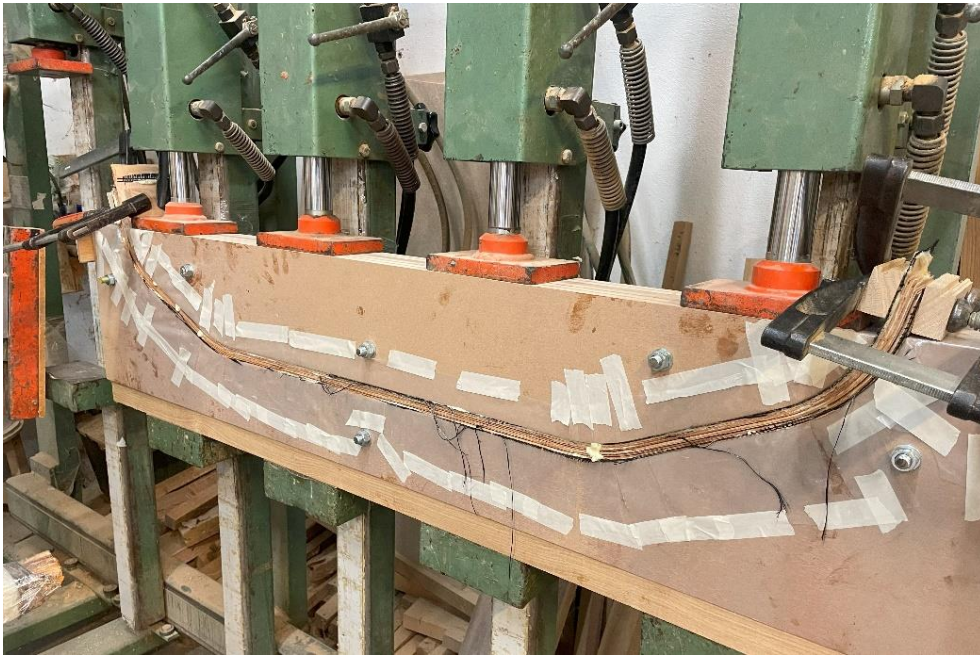
30. ábra Harmadi lökhárító préselése
