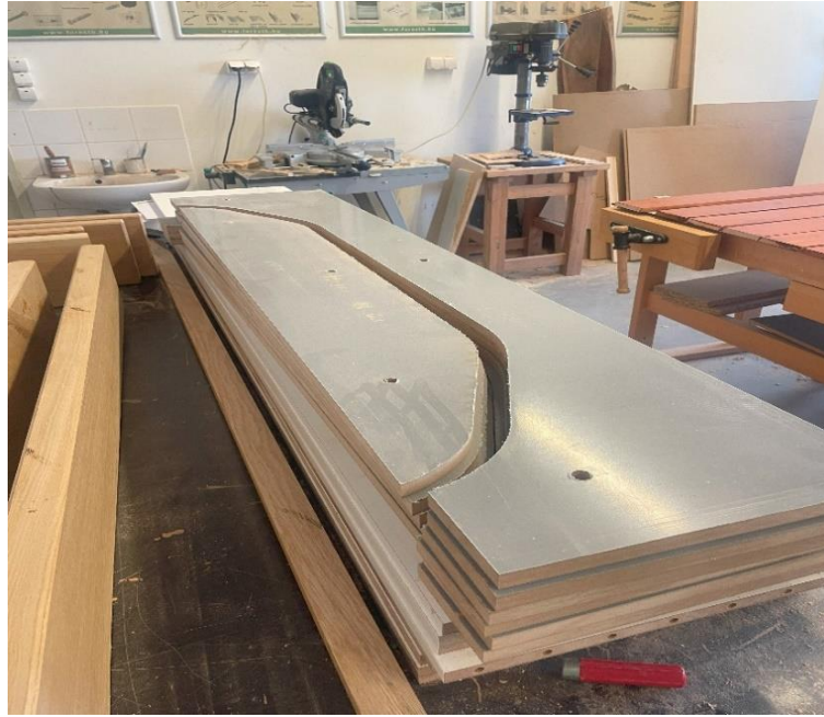
19. ábra CNC gép marása utáni présforma
