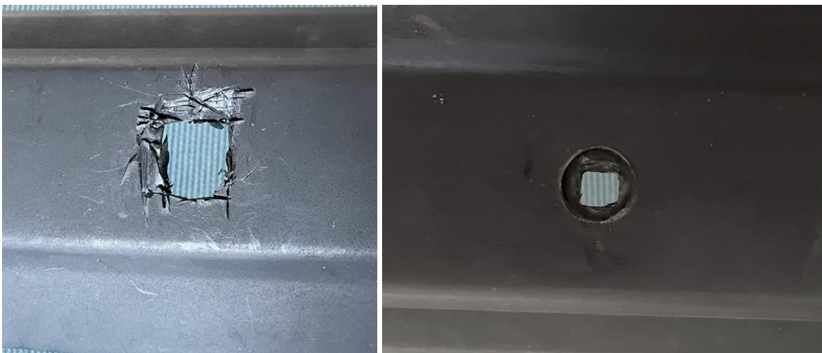
13. ábra Lökhárító rögzítő csavarok helyei (bal sérült jobb nem)
