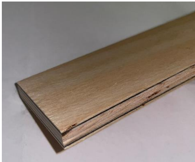
9. ábra Fónagy Gáborral alkotott 9 mm-es szénszálas Biokompozit
