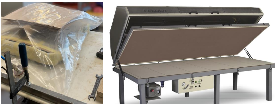
3. ábra: Zsákformázás és membránprés. https://faipar.hu/hirek/kapcsolodotechnologia/10002/furnerozas-a-sikpreselestol-a-membranpresekig .
