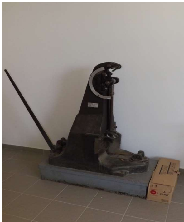
14. ábra Charpy-féle ütő-törő szerkezet (forrás: Takács Dávid, 2024)
