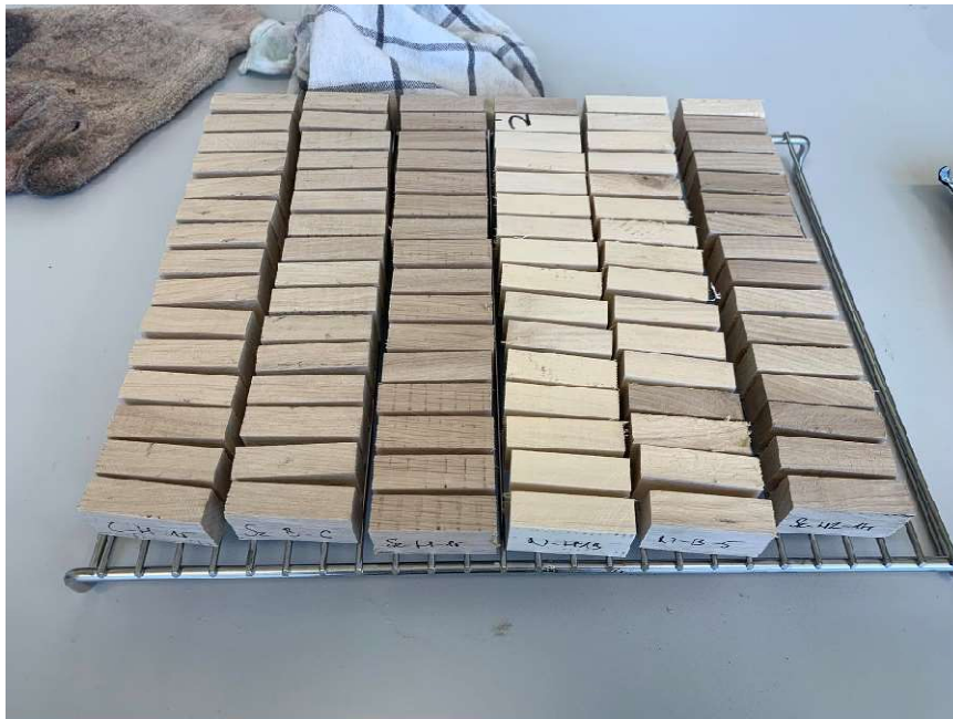
18. ábra Különböző növekedésű gyertyán csoportokból kialakított próbatestek a gombaállósági vizsgálatokhoz (saját kép)
