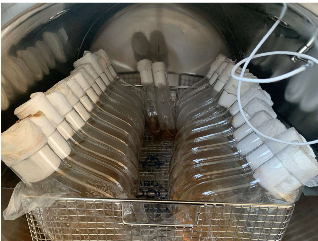
19. ábra Kolle-lombikokba töltött táptalaj, már a sterilizáló gépben
