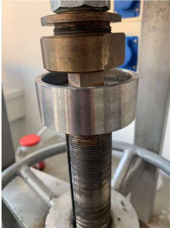
17. ábra Folyadékáteresztési minta befogatása
