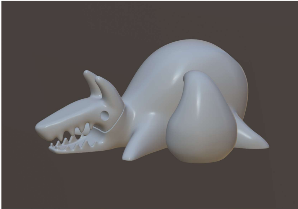
3D szeletelésre kész model, illesztésekkel és vágásokkal a jobb nyomtathatóság érdekében
