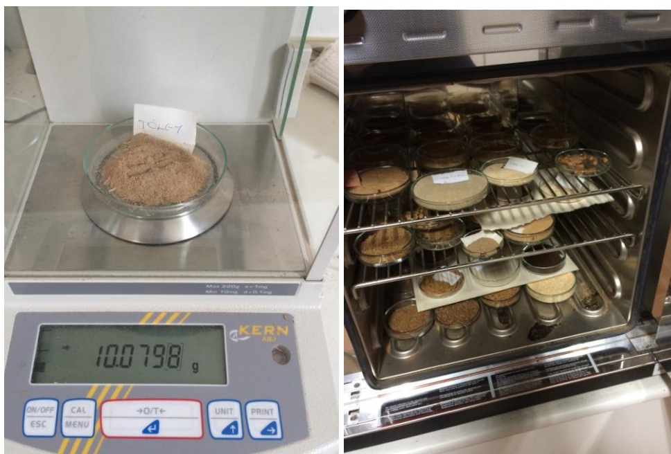
25. ábra. Kern típusú analitikai mérleg és a Memmert típusú szárító szekrény a kimért mintákkal (Saját kép, 2015.09.21.)
