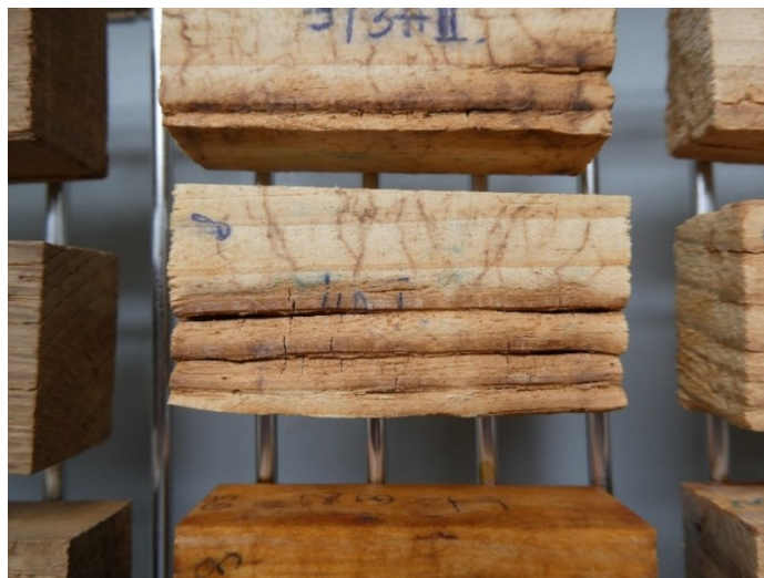
32. ábra: pincegomba bontásképe a szárítókamrából való kivételkor
