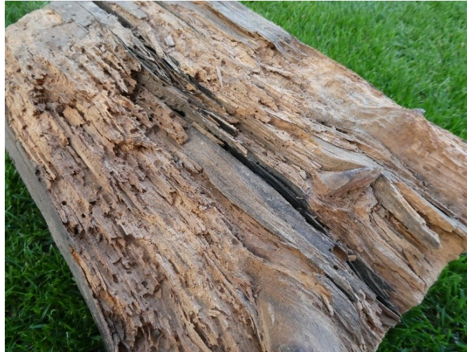
19. ábra: a kibontott erdei fenyő összetett biotikus (farontó gombák és rovarok) károsodása
