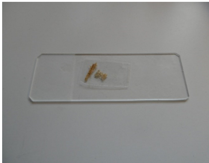
3.ábra: A mikroszkópos fafaj azonosításhoz alkalmazott faminta az üveglapon
