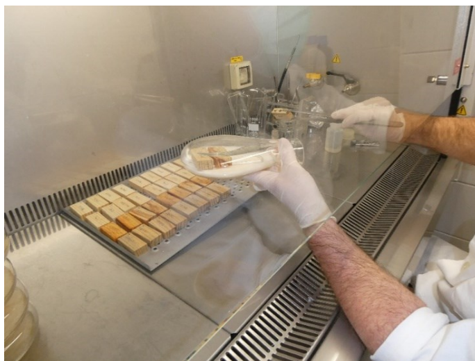
28. ábra: a próbatetek Kolle lombikba helyezése a steril oltófülkében
