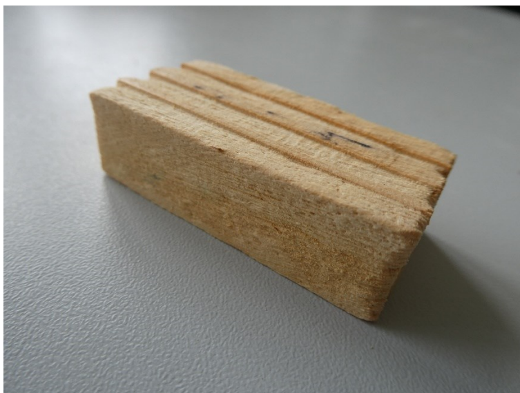
33. ábra: J4All- es mintatest, a beépítésre került erdei fenyő gesztjéből
